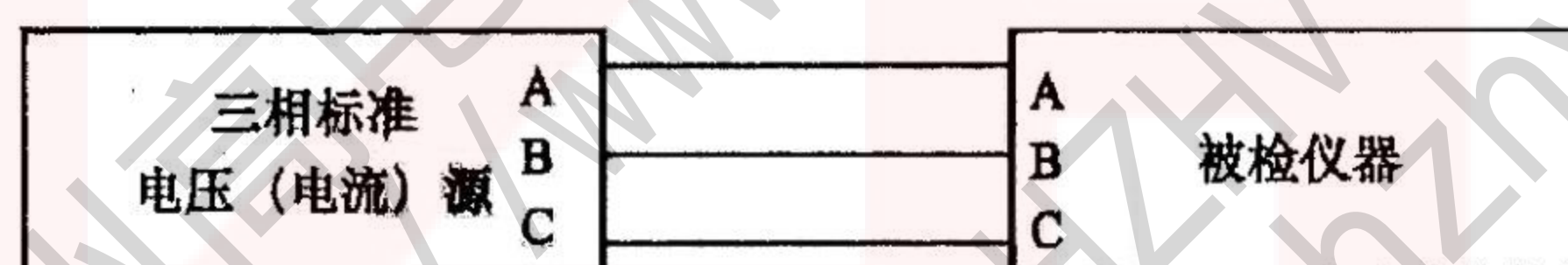
图 11 标准源法三相不平衡度检定示意图
