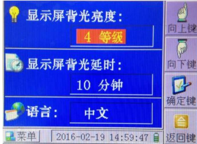
进入“显示设置”界面，软按键有：向上键，向下键，确定键，返回键。
