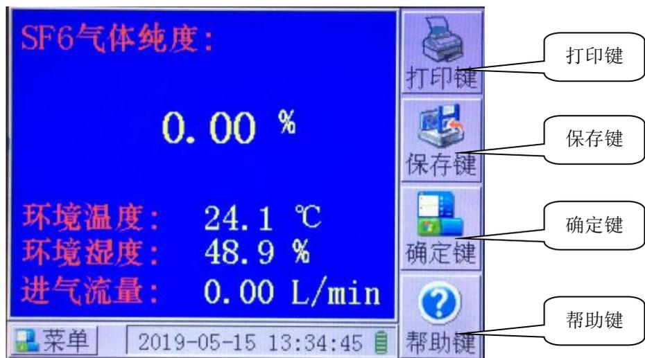
进入“测量界面”后，你可以看到 SF6 气体纯度、环境温度、进气流量、时间日期、电池容量等信息；这时连接好节气管道后，调节流量进气阀，把进气流量调节到 0.2L/min 左右，仪器就会自动进行测量工作。
