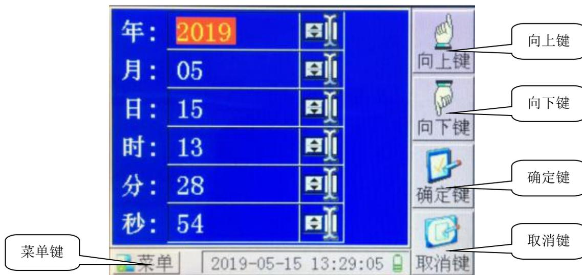
设置时间界面如下图所示：通过【向上】键或【向下】键来选择设置时间或设置日期等，选好对应的项目后，按【▲】键后，对应的数字将增大；按【▼】键后，对应的数字将减小；所有的项目设定完成后，按下【确认】键保存当前设定的数据。
