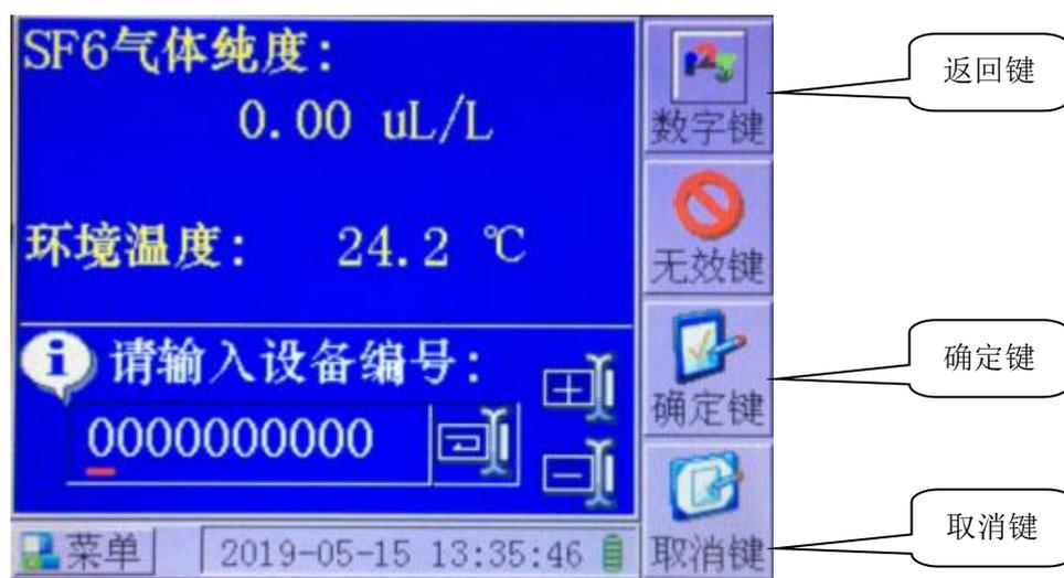
进入“保存界面”后，设备编号的第一位数下的光标在不停闪烁，这样就可以从第一位开始输入数字了，输完第一位按下向右移位键后，输入第二位数，当移动到最后一位时，再按一次向右移位键时，闪烁位将从最后一位返回到第一位；当按【+】键将增大数字值，数字值是从“0”到“9”变化的，当按【-】键将减小数字值，数字值是从“9”到“0”变化的。
