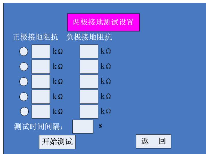
在该界面中，用户可选择 1—5 组两极接地测试点进行测试，被选中的测试组前有 ✓ 做标记，每个测试点可通过点击该测试点后屏幕上出现的虚拟键盘进行设置。
