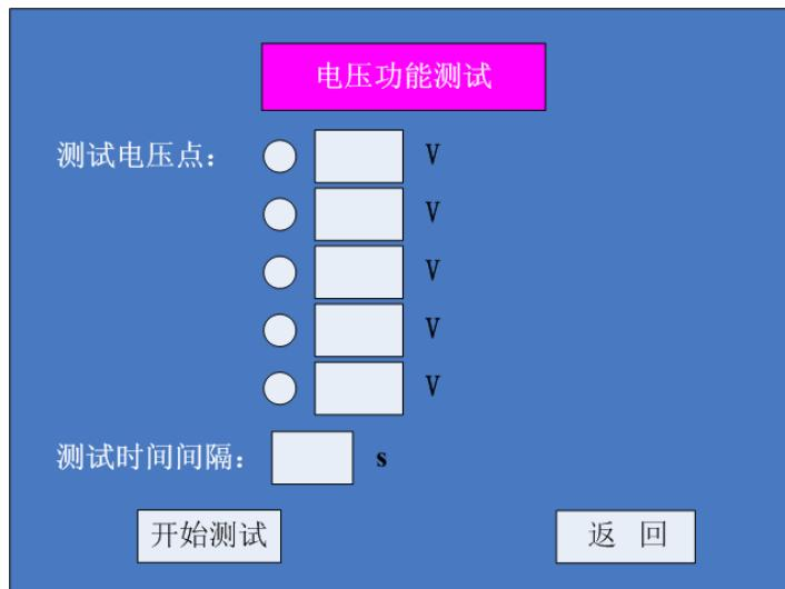
在该界面中，用户可选择 1—5 个电压测试点进行测试，被选中的测试点前有 ✓ 做标记，每个测试点可通过点击该测试点后屏幕上出现的虚拟键盘进行设置。
