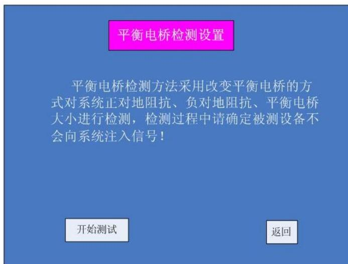
平衡电桥的检测可以为运行维护人员提供系统平衡桥的准确信息，在测试过程中，确定被测设备不会向系统注入信号。
