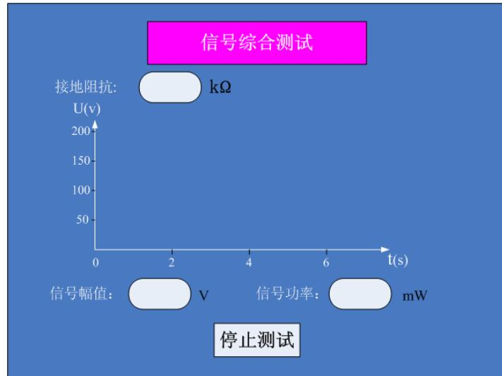
在该界面中，可显示被测设备波形曲线，信号幅值，信号功率等参数，测试过程中可按停止测试按键中止当前测试，返回上一级设置界面。
