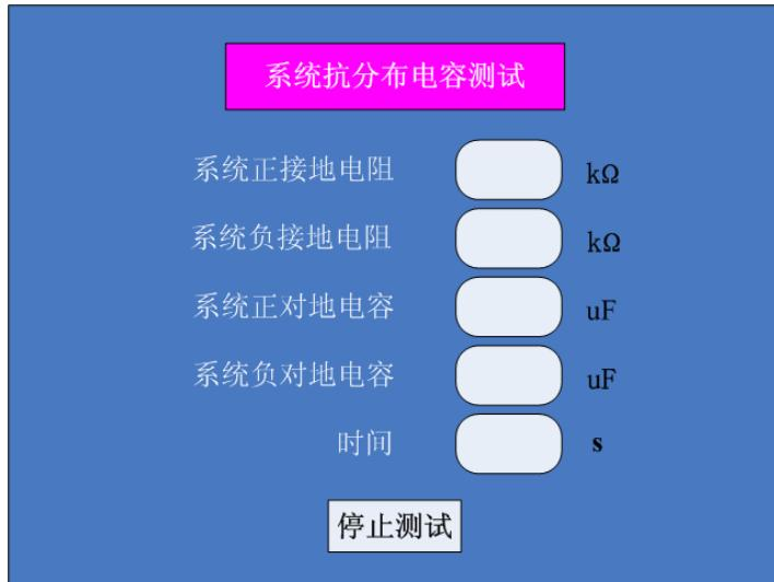
该界面显示出当前系统测试分布电容值与测试电阻阻值，测试时间达到设定的测试时间后，自动返回上一界面，测试过程中，也可按停止测试键中止当前测试，返回上一级设置菜单。
