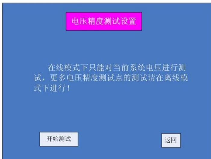
在线模式下的电压精度测试只能测试当前系统电压值，如需对更多电压点的精度进行测试，需在离线模式下进行测试，按下开始测试之后进入测试界面：
