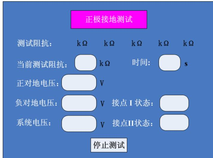
在正极接地测试界面中，测试阻抗一栏显示的为用户选中的测试点；
