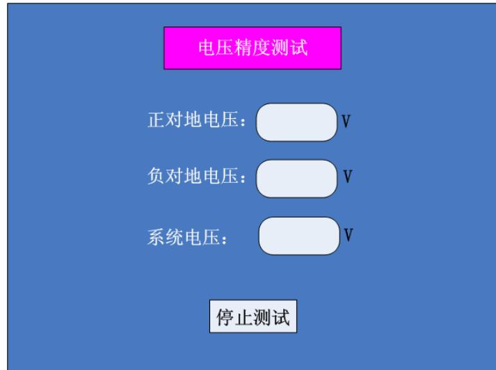
在该界面下，显示正对地电压，负对地电压以及系统正负极之间的电压，通过上述电压测量值与被测装置进行对比，判断其电压测量精度是否附合要求。
