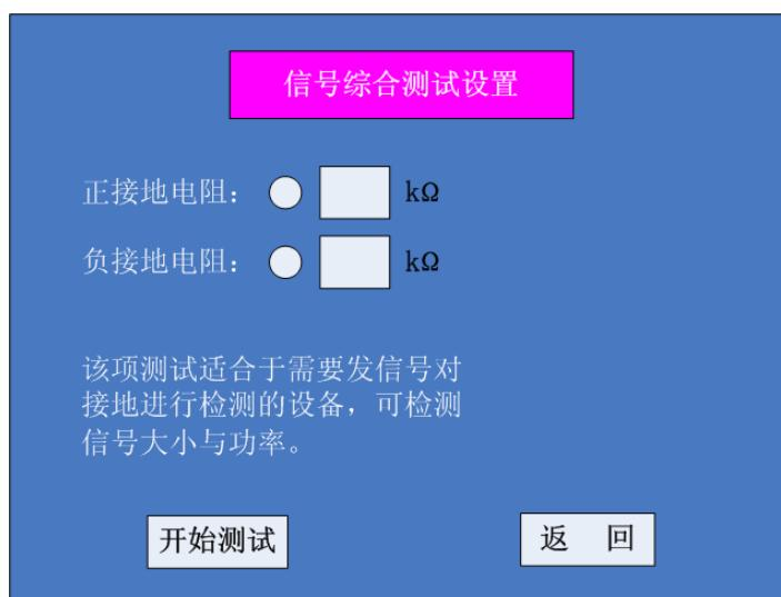
在信号综合测试设置界面中，可以选择信号分析的条件，即正极接地或负极接地，并对接地阻值大小可设定，对测试时间可进行设定；
