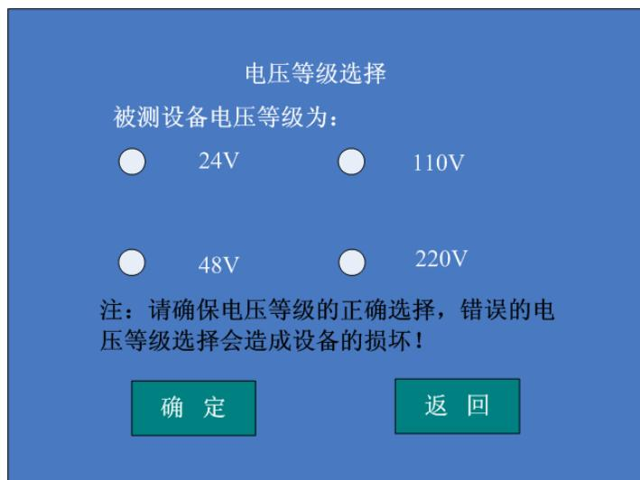
校验仪将根据用户选择的被测设备电压等级来控制合适的直流输出电压，电压等级选择错误将可能造成被测设备的损坏，校验仪共提供了四个电压等级供用户选择。
