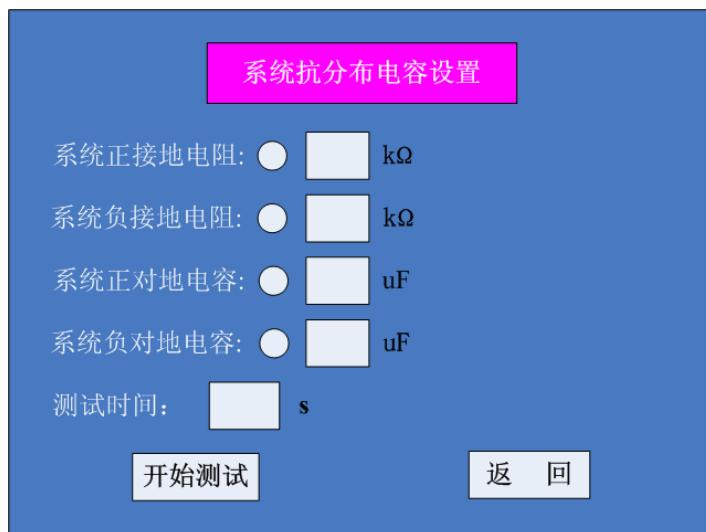
在该设置界面下，用户可对系统正极接地电阻，系统负极接地电阻，系统正对地电容，系统负对地电容进行组合设置，在选中的测试条件前以√做为标记，每个测试条件的电阻值或电容值可进行设定，测试时间可在 5—999S 之间进行设定。
