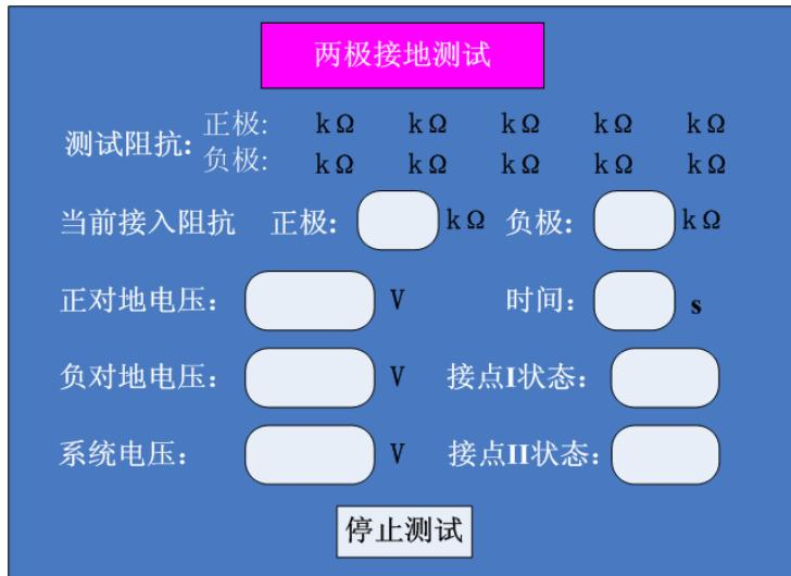
在两极接地测试界面中，测试阻抗一栏显示的为用户选中的测试点；
