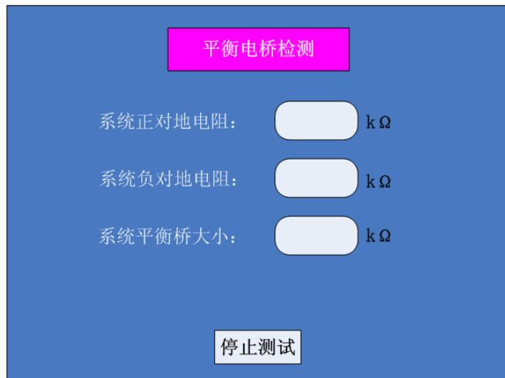
测试完成之后，该检测过程将会计算出被测系统正对地阻抗，负对地阻抗以及系统平衡桥大小。
