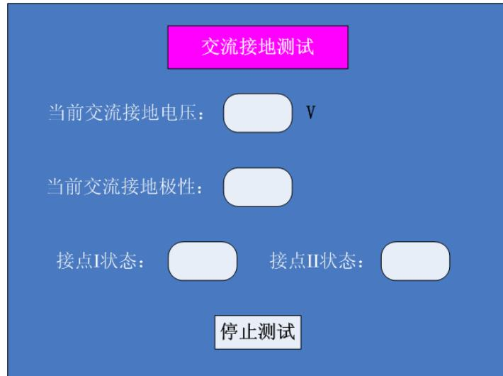
该界面中显示当前系统交流接地电压等极与接地极性，及接点 I 与接点 II 状态，测试过程中可以按停止测试键中止当前测试，返回上一级设置界面。
