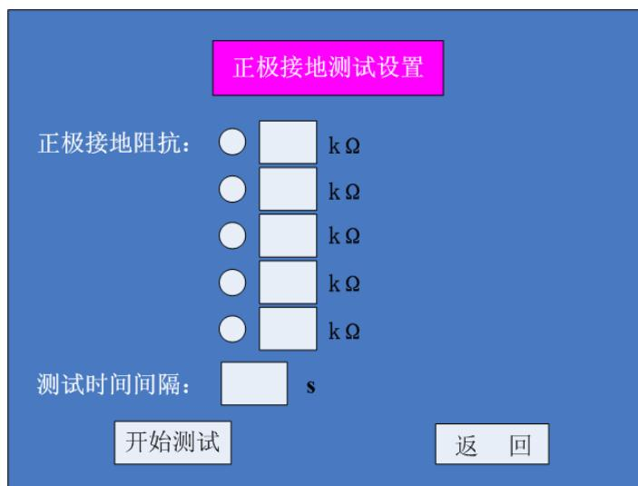
在该界面中，用户可选择 1—5 个正极接地测试点进行测试，被选中的测试点前有 ✓ 做标记，每个测试点可通过点击该测试点后屏幕上出现的虚拟键盘进行设置。
