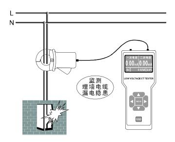
把火线、零线一齐钳住即测量电器设备的漏电流。(需注意 2 根)
