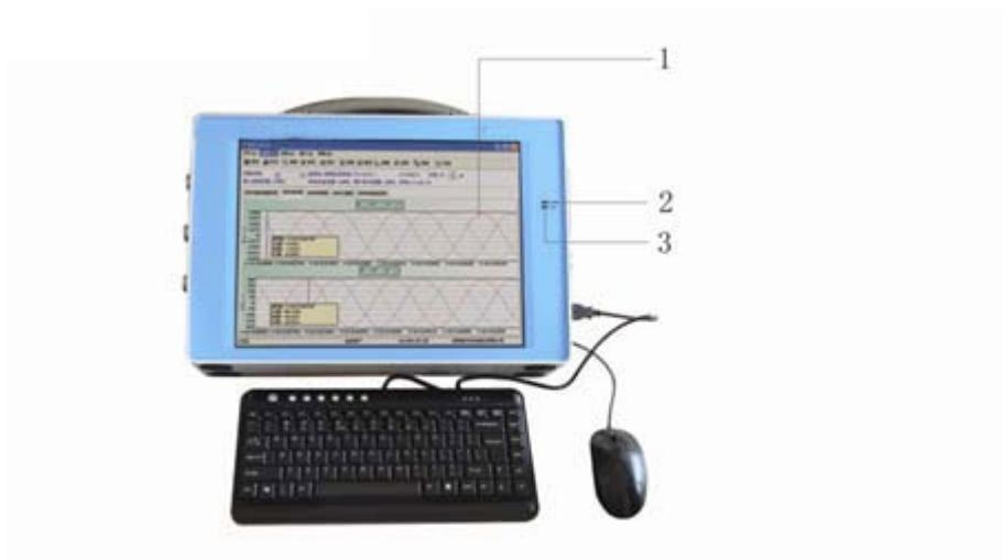
1——TFT 彩色液晶屏；2——电源指示灯；3——工作指示灯；
