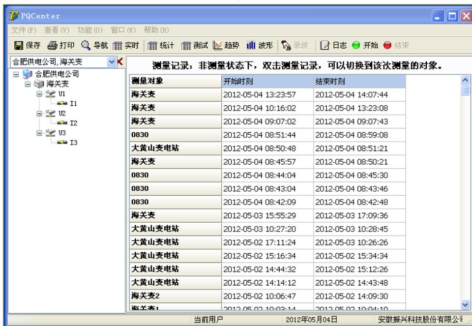
显示区划分为两个区域: 左边的导航区以树形结构的形式显示单位、变电站、电压母线、电流回路等信息, 使用方法类似于 Windows 资源管理器; 右边的工作区用于测量日志和各种报表和及图形显示。
