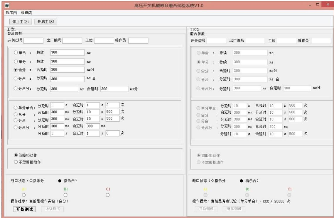
此时可以通过选择需要进行的测试，点击**开始测试**按钮，工位1就执行起操作了。
