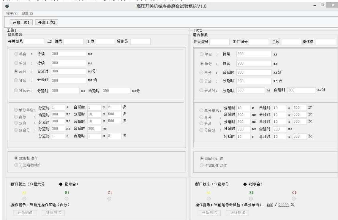
在打开上位机后，实验系统软件是显示两个工位的，在保证开启执行工位后，可以点击软件菜单栏下方的开启工位的按钮，比如点击**开启工位1**按钮，软件会变成如下的模样,即参数部分可以进行编辑以及进行操作了。
