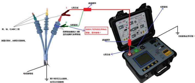
(7) 不使用保护端子 G 时（两线法测量）：
