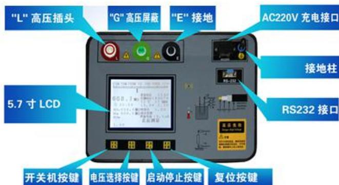
机箱，具有防尘、防水、抗冲击，设计防护等级：IP67 设计抗冲击性能：IK08
