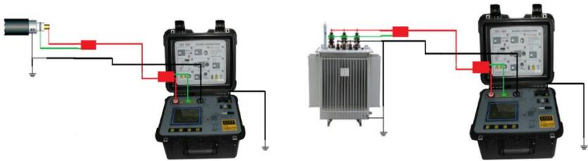
电缆绝缘电阻测试接线
