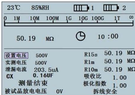
泄漏电流检测：实时检测带负载时的泄露电流变化情况，直观反映出试品的绝缘情况。当电压升到需要试验电压时，泄漏电流不变和逐渐减小，那么绝缘是合格的，反之绝缘有问题。
