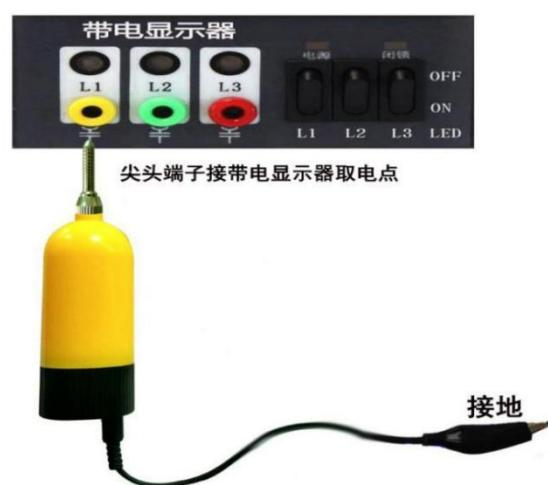
提示：由于带电显示器的主要作用是显示开关柜是否带电，并非标准的核相点，且不同厂家、不同时期、不同标准的带电显示器会产生不同程度的移相问题，且带电显示器 L1、L2、L3 与母线的对应关系不一定正确，若核相结果异常则应在一次线路上进行核相。
