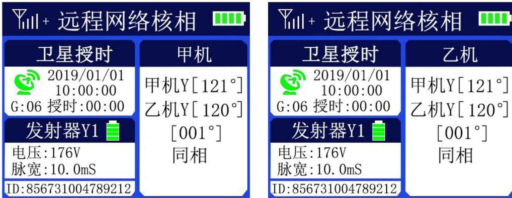
4) 甲机、乙机的切换，在“基站网络定相”页面关机后，再开机切换到“远程网络核相”时，本机为“甲机”，在“基站无网定相”页面关机后，本机为“乙机”，用户可自行切换，甲机需搭配乙机使用。
