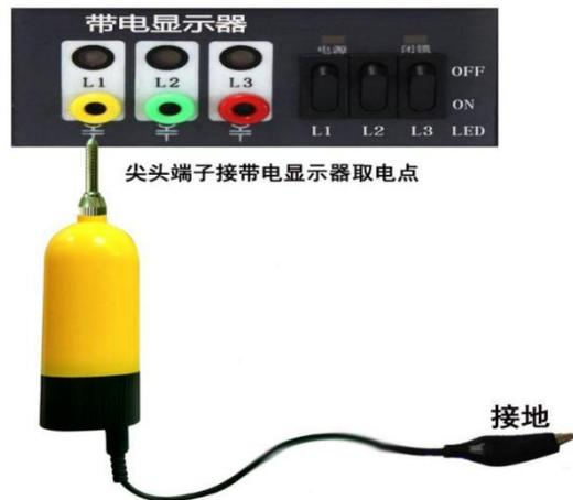
**提示：**由于带电显示器的主要作用是显示开关柜是否带电，并非标准的核相点，且不同厂家、不同时期、不同标准的带电显示器会产生不同程度的移相问题，且带电显示器 L1、L2、L3 与母线的对应关系不一定正确，若核相结果异常则应在一次线路上进行复核，并以一次为准。
