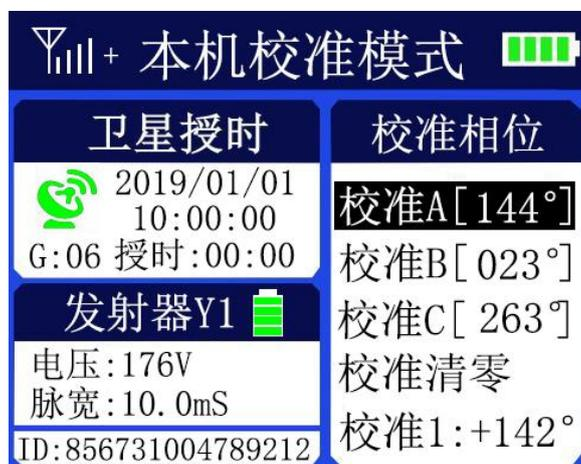
d. 此时该手持机可用于定相使用，为后期使用方便，需将该校准值上报给厂家，厂家将校准值写入云端服务器，用户可在将本机校准值清零、或切换到其他未被校准的校准档位使用。
