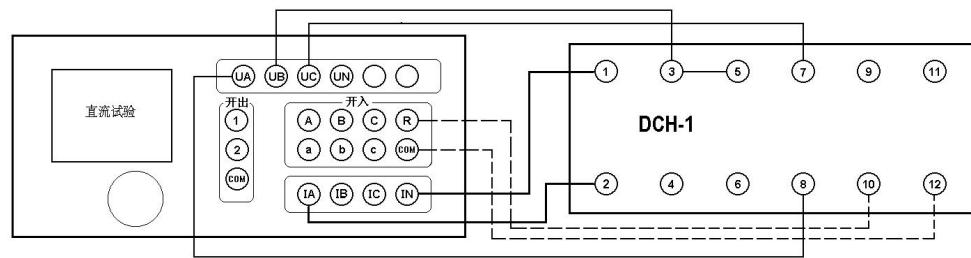
等待 15—25 秒重合闸电容充电充满、信号灯亮后，将 Uc 电压值改为 -110V (在输出状态中，鼠标点击 Uc 数值框，直接输入 -110，按回车键)，即在第 7 端施加启动电压以启动重合闸，重合闸启动后，等待重合闸时间到，接点动作，即可测出动作时间。
