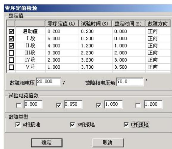
“启动值”栏用于测试保护的启动电流。保护是否启动往往可以从保护的启动指示灯上观察到。也常常用来替代 I 段，从而由“启动值”、“I 段”、“II 段”一起构成保护的 I、II、III 三段，这里的“故障方向”可以根据需要进行选择，在“正向”或“反向”的方框内单击可以相互切换。
