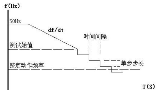
这里逐格变频的时间间隔是根据整定的动作时间自动确定的，该时间间隔比整定动作时间长 0.2S。故整定动作时间应设置正确，以保证在变化时间间隔内保护有足够时间可以动作。
