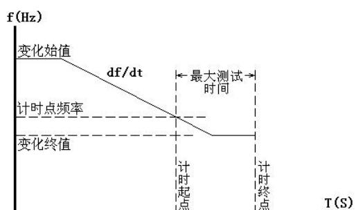
测动作时间时，应特别注意正确设置“开始计时点的频率”。一般设置为装置整定的动作频率，或测试出的准确动作频率值。
