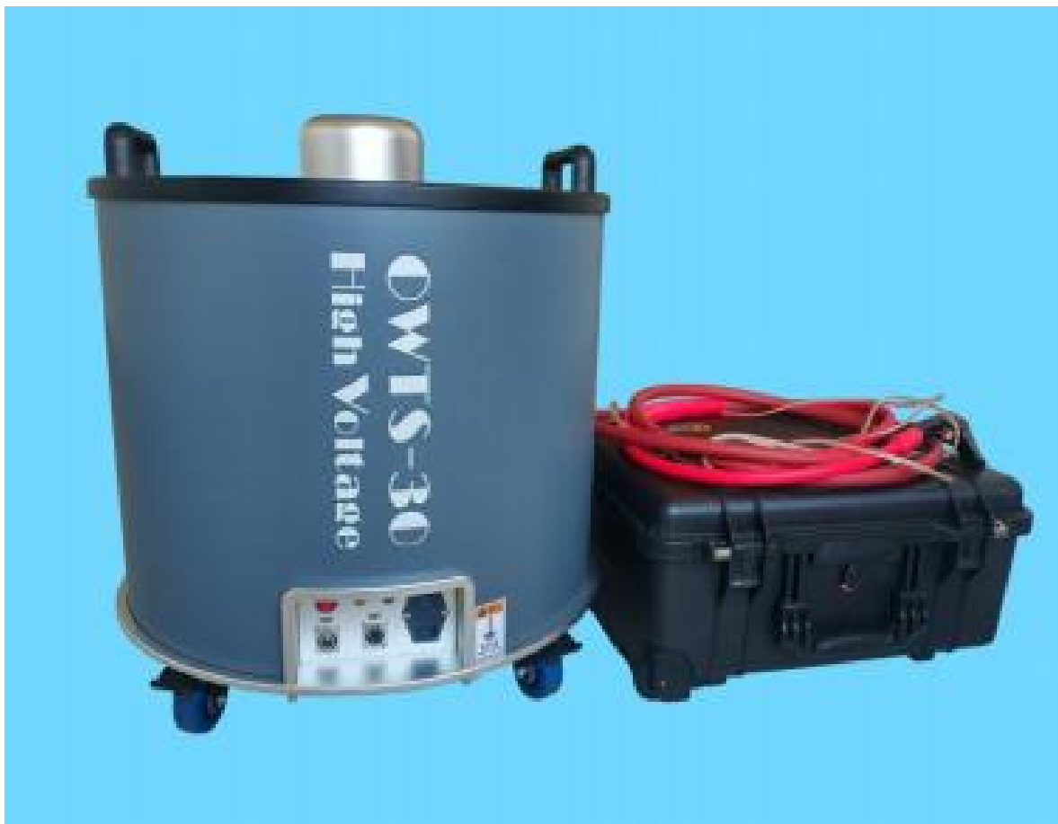
图 1 CT-OWTS 型 10kV 电缆振荡波局部放电检测系统
