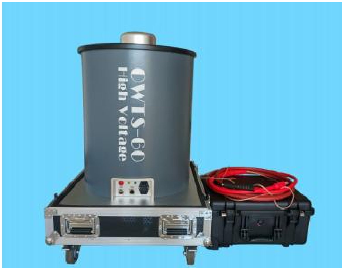
图 2 CT-OWTS 型 35kV 电缆振荡波局部放电检测系统
