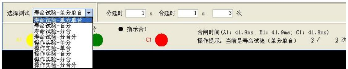
可以看见有九种测试可以选择，总的来说分为两大类，分别为“寿命试验”和“操作实验”，寿命测试实际上是一种循环测试，可以设置循环次数。每种测试的测试参数设置各不相同，参数设置区域位于“选择测试”区域的右边，下面各图是每种测试对应的测试参数：
