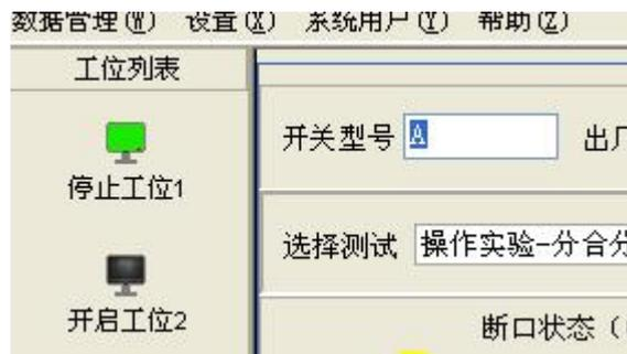
右侧区域会出现“工位1”的测试界面（此时如点击“停止工位1”按钮，则软件会断开位于工位1上的仪器，右侧“工位1”的测试界面消失）。测试界面如下图：
